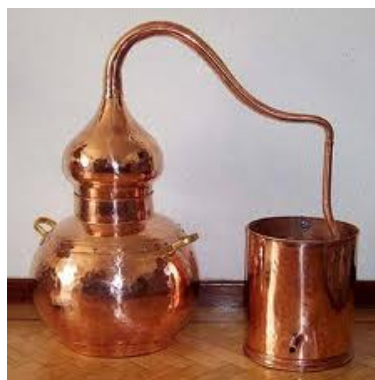
Figura 2 – Alambique de cobre (a mistura a destilar é aquecida no lado esquerdo e os vapores condensados numa espiral do lado direito dentro do reservatório com água).
