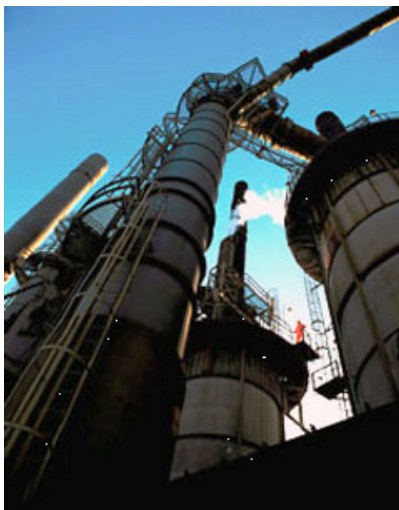
Figura 4 – Coluna de destilação para fraccionamento de petróleo. [2]
