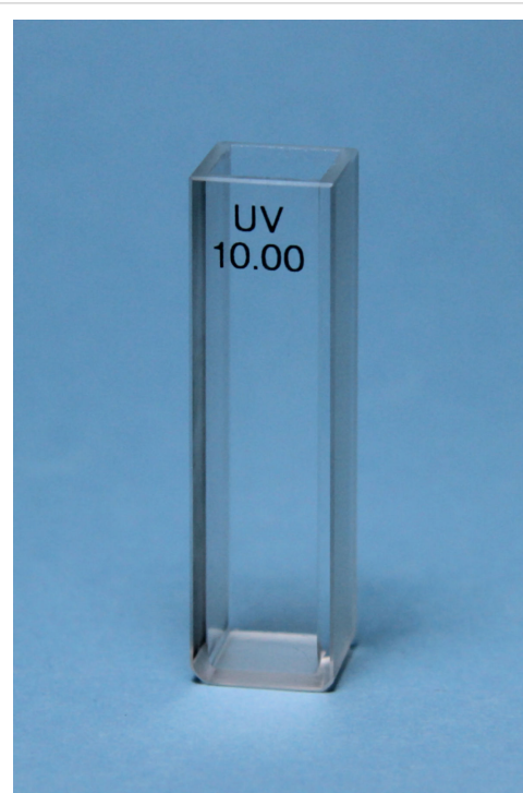
Figura 1 Cuba de quartzo utilizada em espectrofotómetros com um passo ótico de 10,00 mm.
